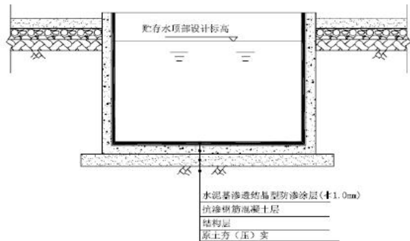
图 5-32 地下池体防渗结构图
